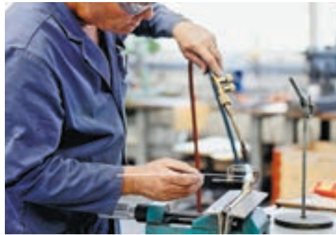
2 Das Messing wird gewalzt und zusammengelötet.
