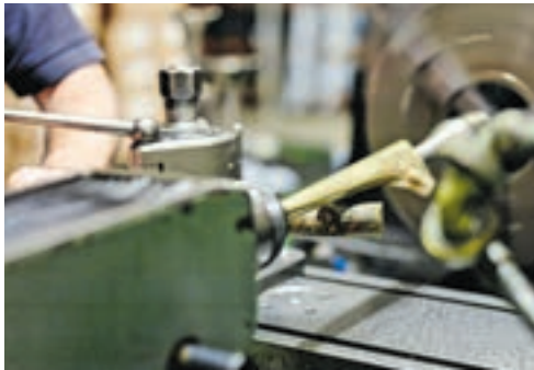
3 An der Werkbank wird der Schallbecher «gedrückt».
