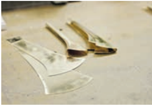
1 Aus Blech werden trompetenförmige Teile gestanzt.
