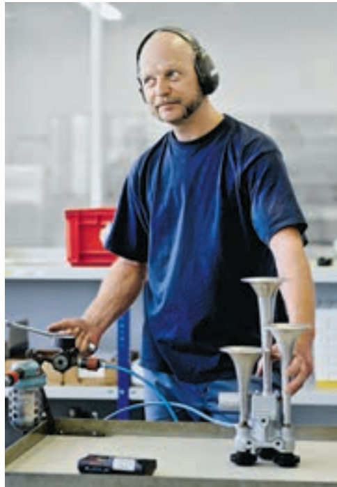
7 Zum Schluss wird das Posthorn gestimmt. Nicht nach Gehör, sondern durch Messen der Frequenzen.
