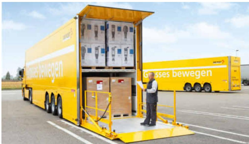
Ces mastodontes font plaisir à voir: 28 semi-remorques à deux plans de chargement transportent des colis pour la Poste. Avec leurs deux étages, ils offrent une capacité de chargement supplémentaire de 50%. Le calcul est simple: grâce à sa flotte de semi-remorques à deux étages, la Poste économise chaque année plus de 420 000 litres de diesel et réduit de 1100 tonnes ses émissions de CO<sub>2</sub>. *an*
