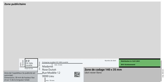
Exemple d'un envoi sous film plastique pour une liasse par localité (à partir du format B5 jusqu'au format B4 horizontal)
