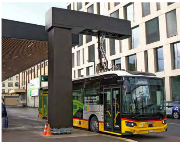
Der Pantograf senkt sich zum Aufladen der Batterie von oben auf das Dach des Fahrzeugs. Geladen wird Solarenergie.
