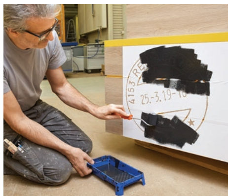
In der Montage werden die Einzelteile zusammengebaut. Ruedi Geissbühler, Oberflächenspezialist, bringt die Schablone für den Poststempel an.
