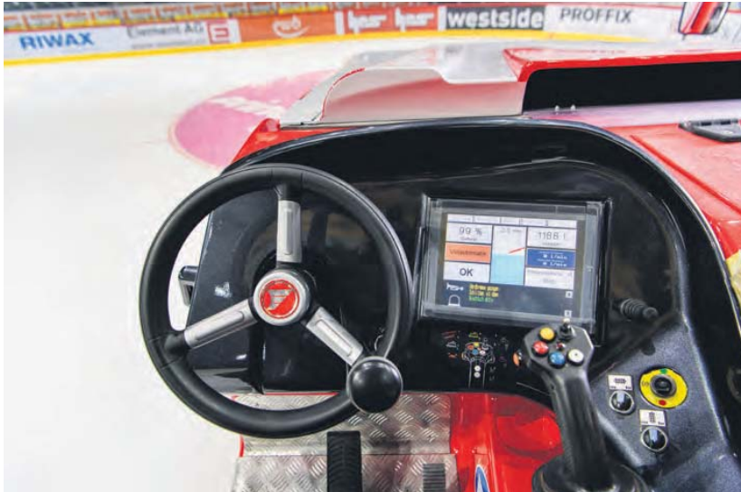
Poste de pilotage de la surfaceuse que pilote Marcel Gerber. Cette machine qui rabote la glace contient plus de 1000 litres d'eau.
