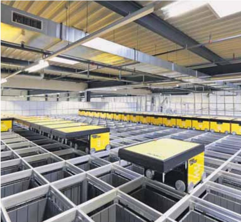
Sans bruit, les robots électriques jaunes glissent sur une structure de rails en damier.
