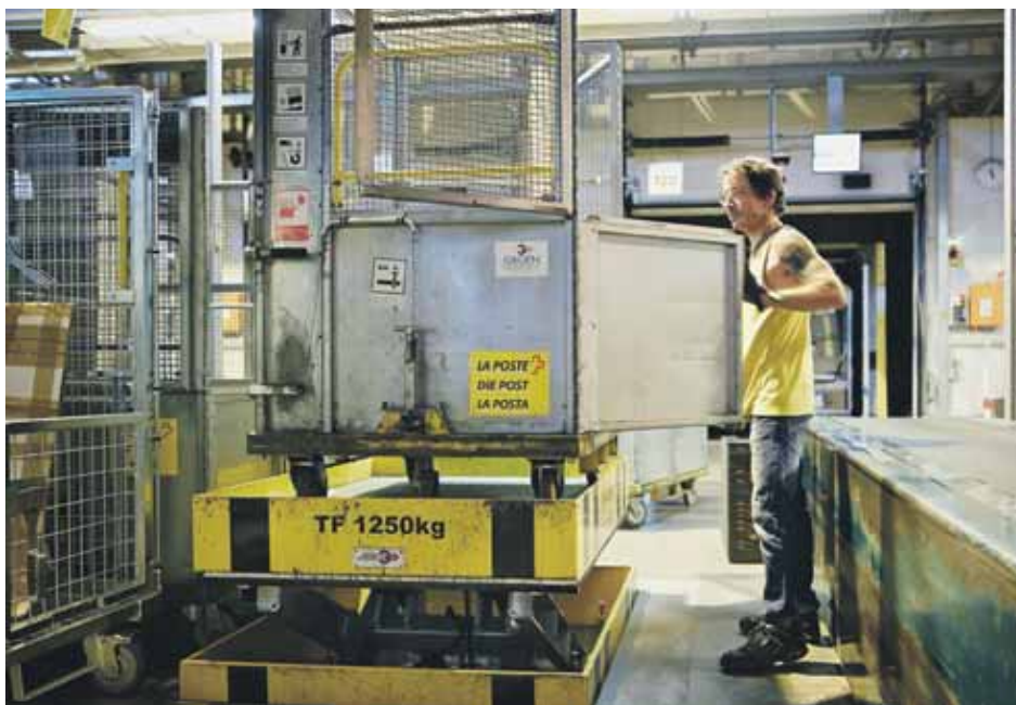
La plate-forme réglable permet de charger et de décharger les colis à une hauteur idéale.
