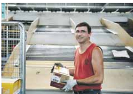
La plate-forme réglable permet de charger et de décharger les colis à une hauteur idéale.
